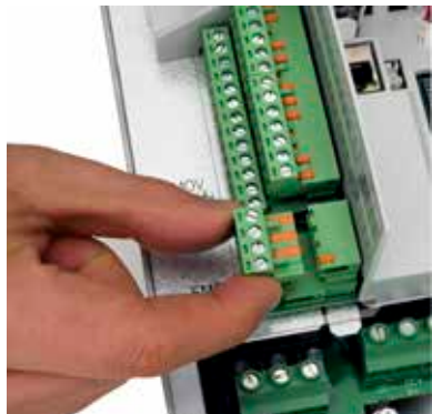
Kolay ayrılabilir I/O bağlantı terminali
